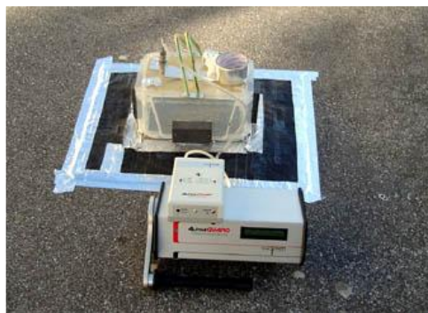
Figura 28- Sistema AlphaGuard para medição de radão e descendentes. Fonte: www.dct.uc.pt/lrn . Acesso em Novembro de 2011.
