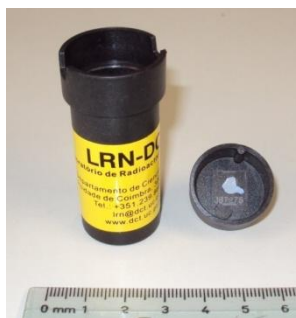
Figura 25- Detetor de radão CR-39 (colado à tampa) e respetiva câmara de difusão (recipiente negro): dispositivo usado no estudo de campo realizado no âmbito deste trabalho.
